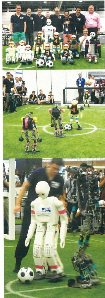
ロボカップ（RoboCup）は、ロボットとAIの新しい標準問題として「2050年人型ロボットでワールドカップ・チャンピオンに勝つ」ことを設定。その研究課程で生まれる科学技術を世界に還元することを目標とした国際的ロボット競技大会。ボン大学は2017年に開発した身長135cmのアダルトサイズで優勝。さらにティーンサイズ（90cm）でも優勝した。アダルトサイズは背が高いため転倒しやすく、転倒するとその重量で壊れてしまう可能性が高いため、ロボット1体に対して1人の人間がつく。
