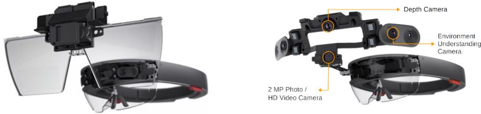
Abbildung 3.2: Die holographischen Linsen (links) und die Sensoren (rechts) der HoloLens (Microsoft 2018d)
