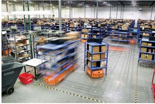
Bild 2: Kiva-Transportroboter im Versandhandel [61].
