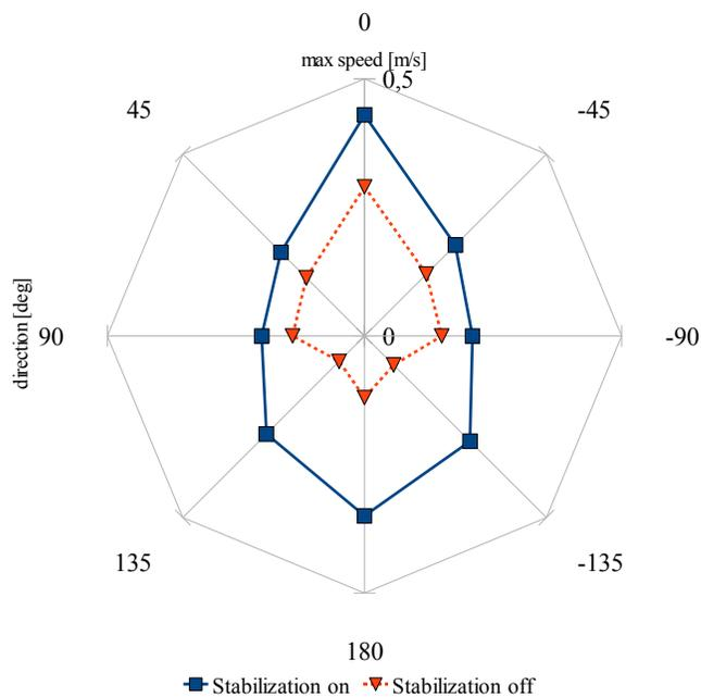
Fig. 11. Maximum Walking Speeds for DD2008
